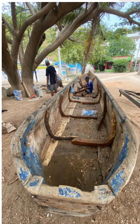
Ilustración 3: Reparación de cuadernas de canoa Monóxila en Taganga. Foto: Wilhelm Londoño
